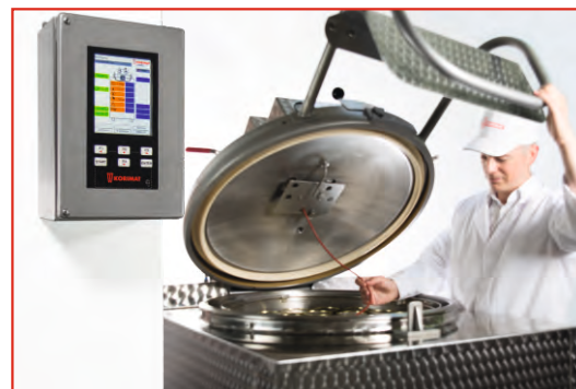
Das Bedienfeld der Kochprozesssteuerung wird separat montiert, liefert und speichert alle Informationen und bietet die Möglichkeit zum berührungslosen Datenaustausch.
