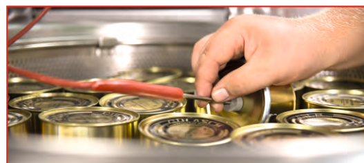
Per Stichsonde wird der Kochvorgang im Produkt gemessen.
